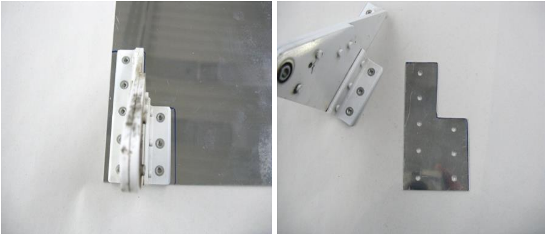
FIGURA 4: PREPARANDO O GUIA DE FURAÇÃO
