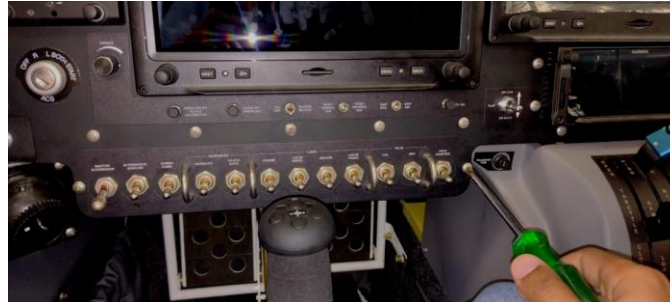
Figura 6 - Inserção da fixação da chapa de proteção das chaves seletoras.
