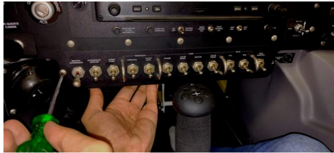
Figura 3 - Remoção da fixação da chapa de proteção das chaves seletoras.
