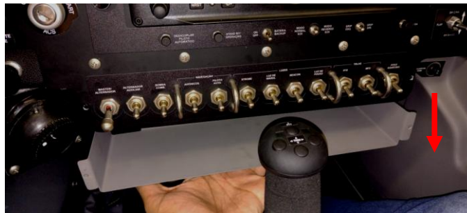
Figura 4 - Remoção da chapa de fixação das chaves seletoras.
