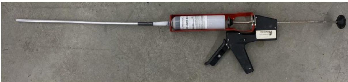
FIGURA 8: FERRAMENTA PARA APLICAÇÃO DE SELANTE COM TUBO DE ALUMÍNIO DE 3/8 POLEGADAS FIXADO COM FITA ADESIVA NA PONTA DO BICO DO RECIPIENTE DE SELANTE DE TANQUE DE COMBUSTÍVEL MC-236-B1/2
