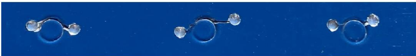
FIGURA 3: TRINCAS COM FURAÇÃO NO PROFUNDOR DO RV-14A
