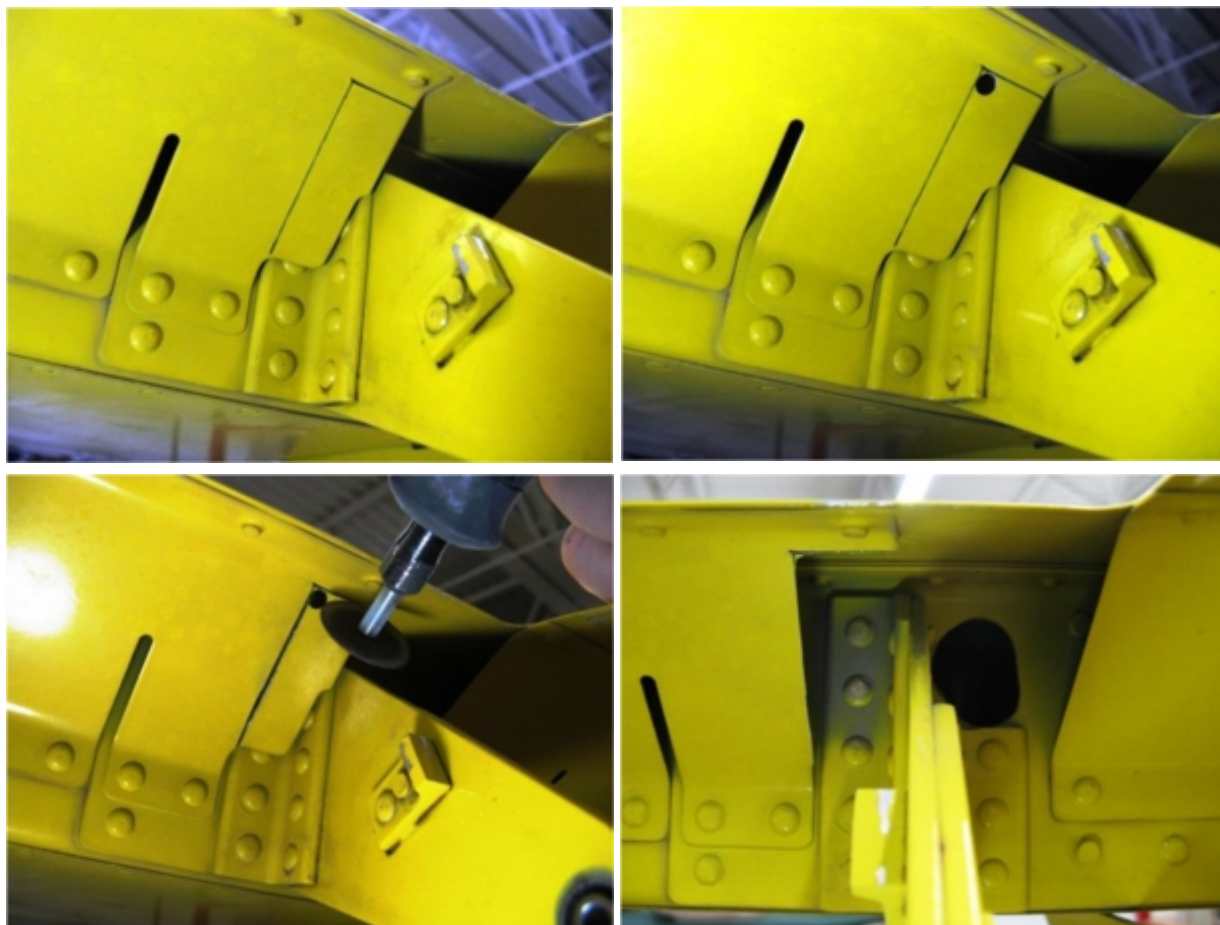
FIGURA 3: AJUSTE DO ESPAÇADOR DA CARENAGEM DO AILERON
