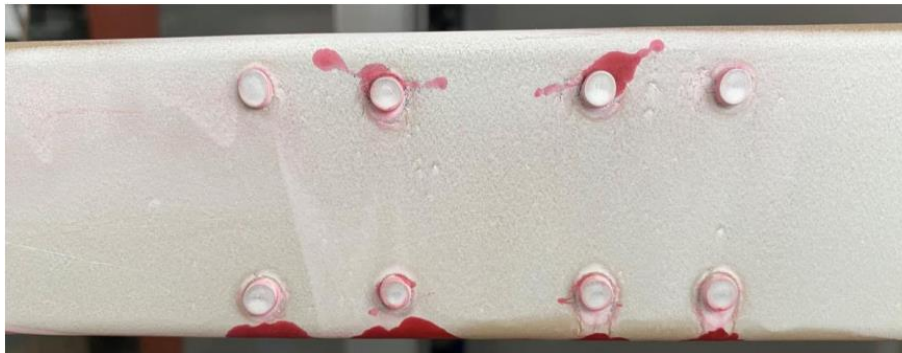
Figura 4 - Localização da trinca - Vista dianteira da longarina
