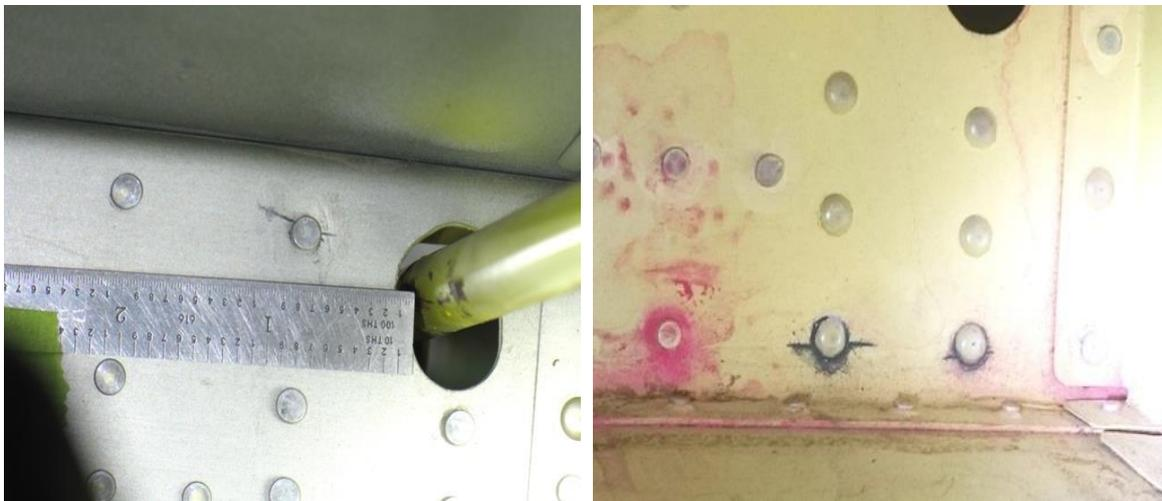
**FIGURA 1: TRINCAS No BORDO DE FUGA**
