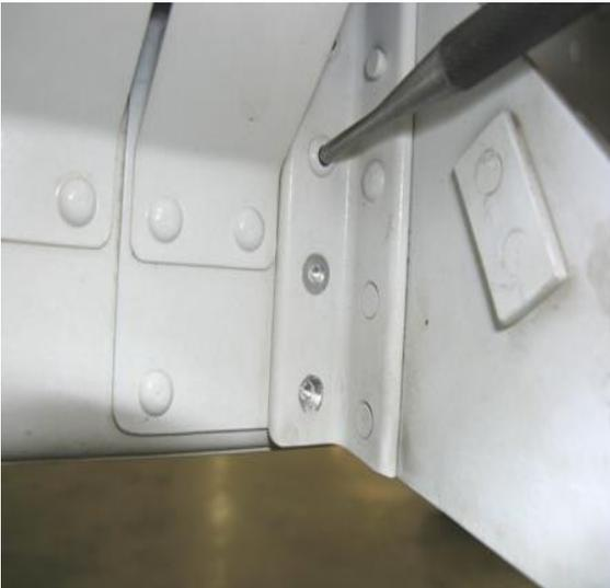
3. Retire as cabeças dos rebites utilizando um pino de punção de 1/8" ou a extremidade traseira da broca #30.
