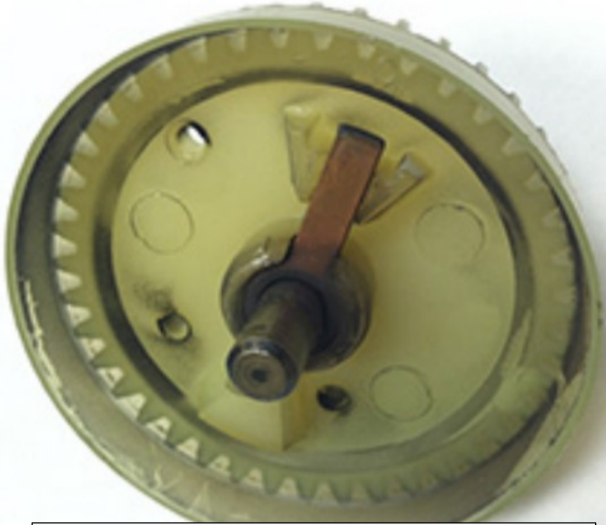
Figura 3. Engrenagem do distribuidor K3008 afetado com eletrodo
